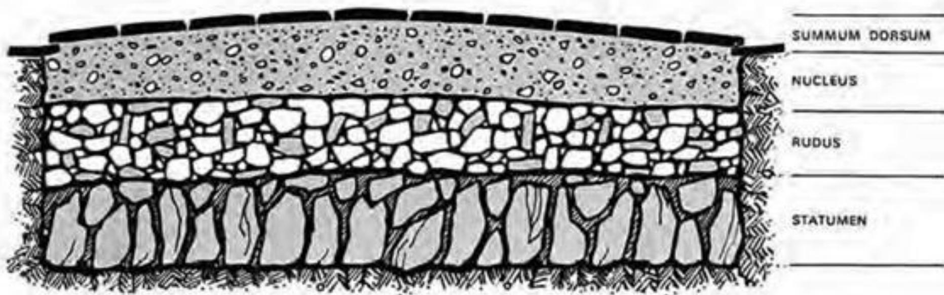
Fig. 1 Sezione di una strada romana secondo il modello proposto da Bergier nel 1622.
