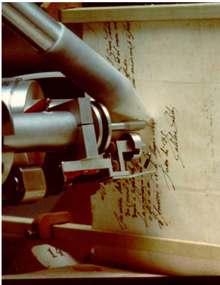
Una lettera di Galileo durante l'analisi PIXE
